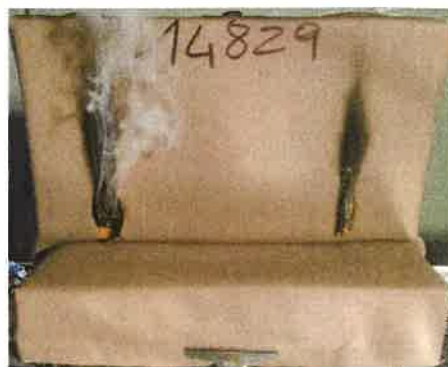
Il secondo innesco sulla provetta
