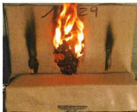
La provetta prima dello spegnimento esterno
