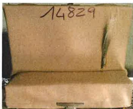
Il primo innesco sulla provetta
